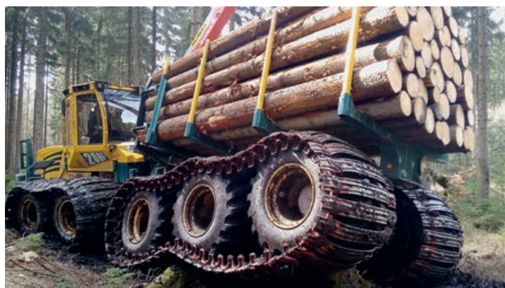
Abb 1 Triple-Bogie-Achse im Härtestest.
