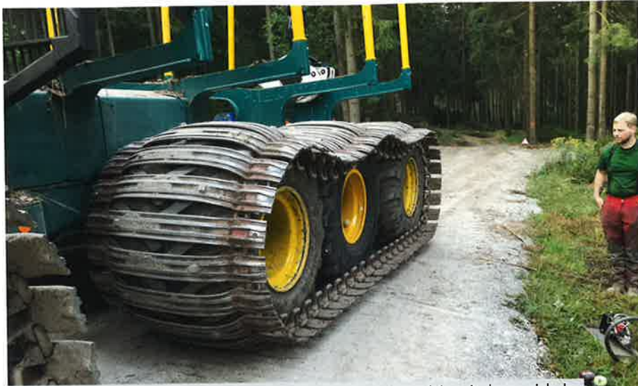
Die dreifache Bogie-Hinterachse: Eines der fünf optionalen Module, mit denen sich der neue Forwarder an die individuellen Bedürfnisse des Kunden anpassen lässt.
