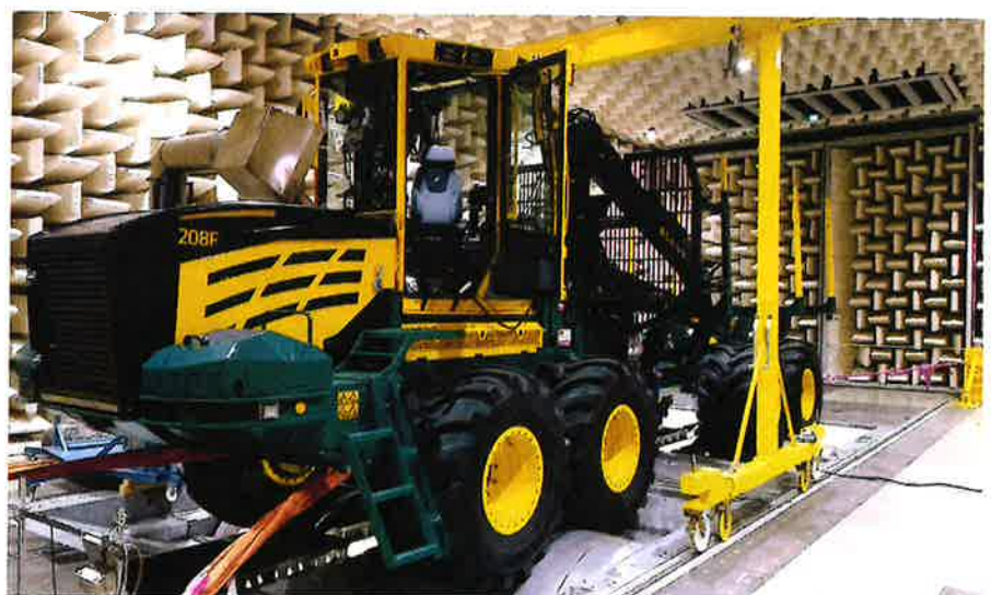
Nach der Referenzmaschine bewies ein Forwarder mit leistungsverzweigtem Getriebe auf dem Prüfstand seine Stärken.
